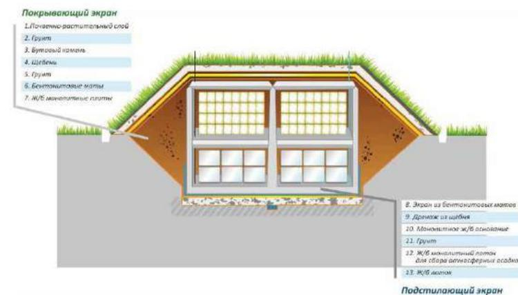
Если посмотреть на пример конструкции пункта захоронения, предназначенного для приповерхностного захоронения РАО 3 и 4 классов, то сразу становится понятно, что эти объекты не имеют ничего общего с ядерным реактором.
