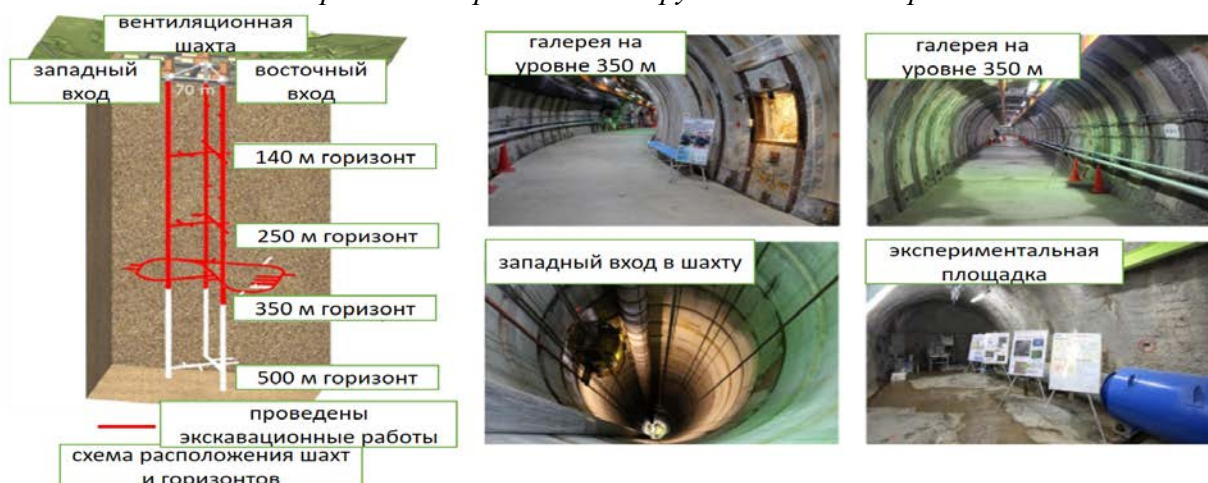
Схема шахт и горизонтов проекта планируемой ПГЗРО Хоронобэ
