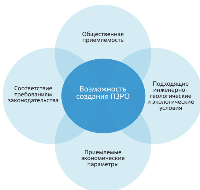
Рис. 3. Основные принципы размещения пунктов окончательной изоляции РАО
