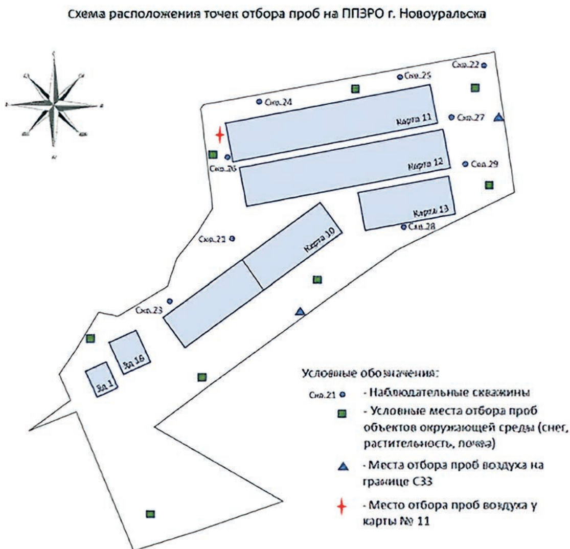
Рис. 9. Условные места отбора проб объектов окружающей среды (снег, растительность, почва), места расположения наблюдательных скважин филиала «Уральский»
