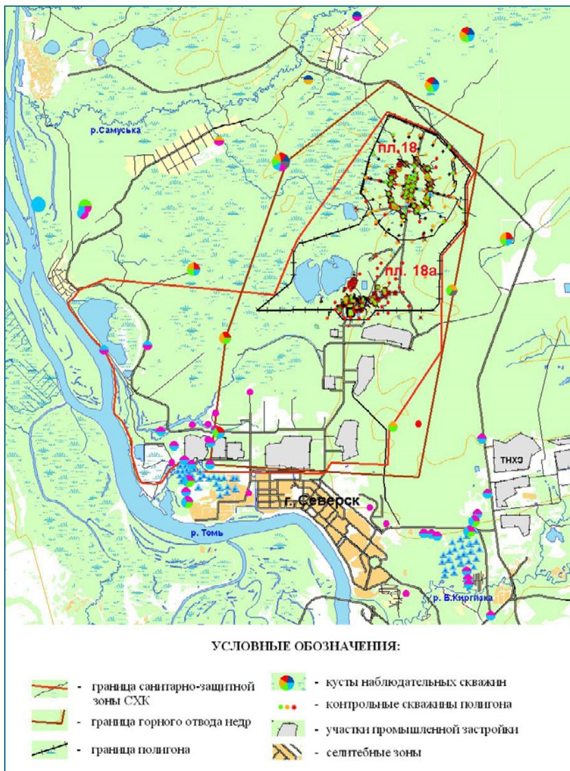
Рисунок 10. Схема расположения наблюдательных контрольных скважин ПГЗ ЖРО филиала «Северский» ФГУП «НО РАО»
